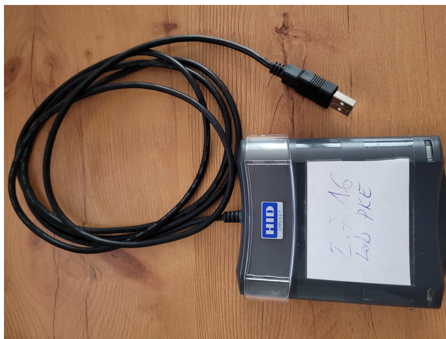
RYSUNEK 2.1: Czytnik RFID wypożyczony z laboratorium Politechniki Poznańskiej identyczny z czytnikiem stosowanym w Bibliotece Politechniki Poznańskiej.
