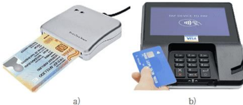
Rysunek 2.3 Typy kart ze względu na sposób przesyłania danych: a) karta stykowa wraz z czytnikiem, b) karta bezstykowa wraz z czytnikiem [1].
